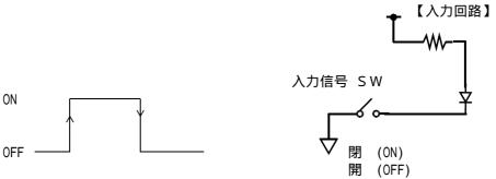
**B接 OFF アクティブ** (A接の逆です) ノーマル閉(ON) <del>→→</del>開(OFF)で動作 一般に±OT や非常停止は、B接にします。(フェイルセーフのため)
