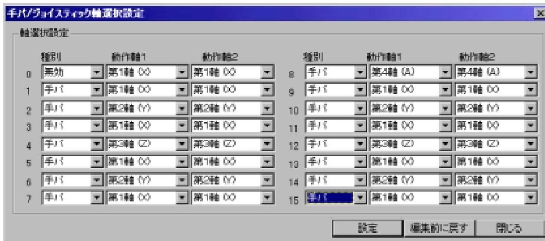
機械操作パネルの手パ軸選択入力の入力パターン(0～15：0000～1111)に対して手パの有効／無効、及び動作する軸を選択します。
