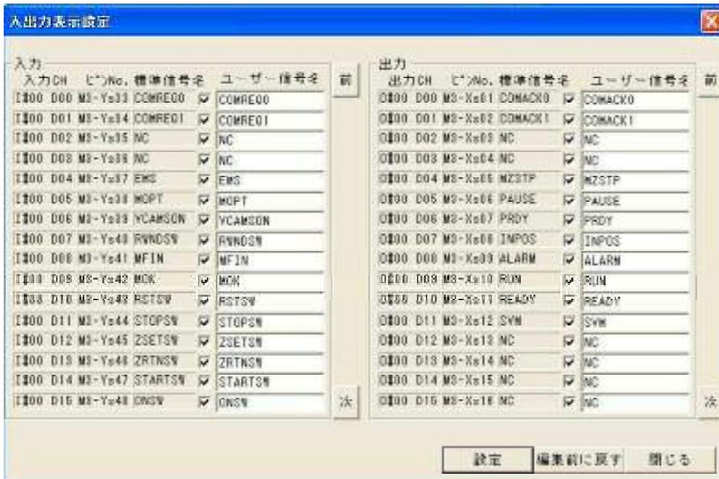
入出力モニタリング画面では、チェックボックスにチェックされている入出力信号のみ表示します。
