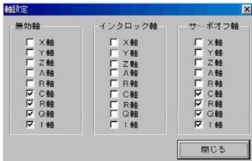
設定変更したい軸のチェックボックスをチェック (  ) する事によりON状態/OFF状態を設定します。ON, OFF状態はトグルで切り替わります。
