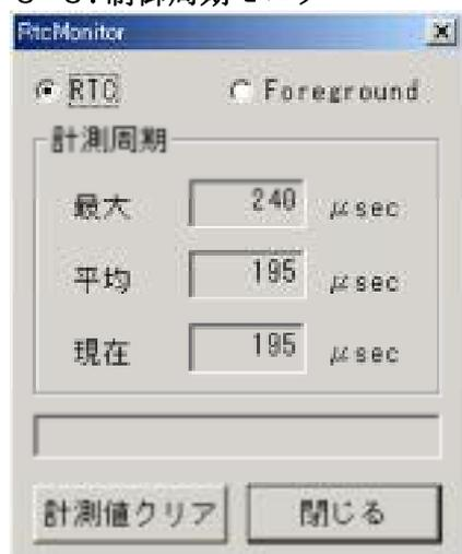
RTC 割り込み処理の実行時間。割り込み周期以下である必要があります。実行時間が制御周期を越えると「制御周期負荷過大」になります。実行時間が制御周期の99.6%を越えると「制御周期負荷ワーニング」になります。
